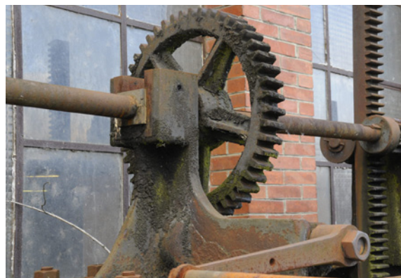
Détail du pignon Sud de l'usine permettant d'ouvrir des vannes. Photographie Claude Nardin © ADU.
